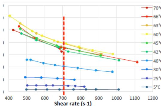
각 시료는 하나의 실험조건으로 분석되었고, Shear Range는 500 ~ 1,000 s<sup>-1</sup>이고 다양한 온도에서 분석되었다. 상기 그림은 시료 20.1% 용액을 온도별로 분석한 결과이다.
